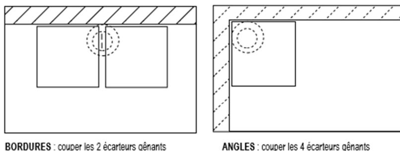
Le DTU 43.1 requiert l'utilisation de plots dont la hauteur (H) est comprise entre 50 et 200 mm.
