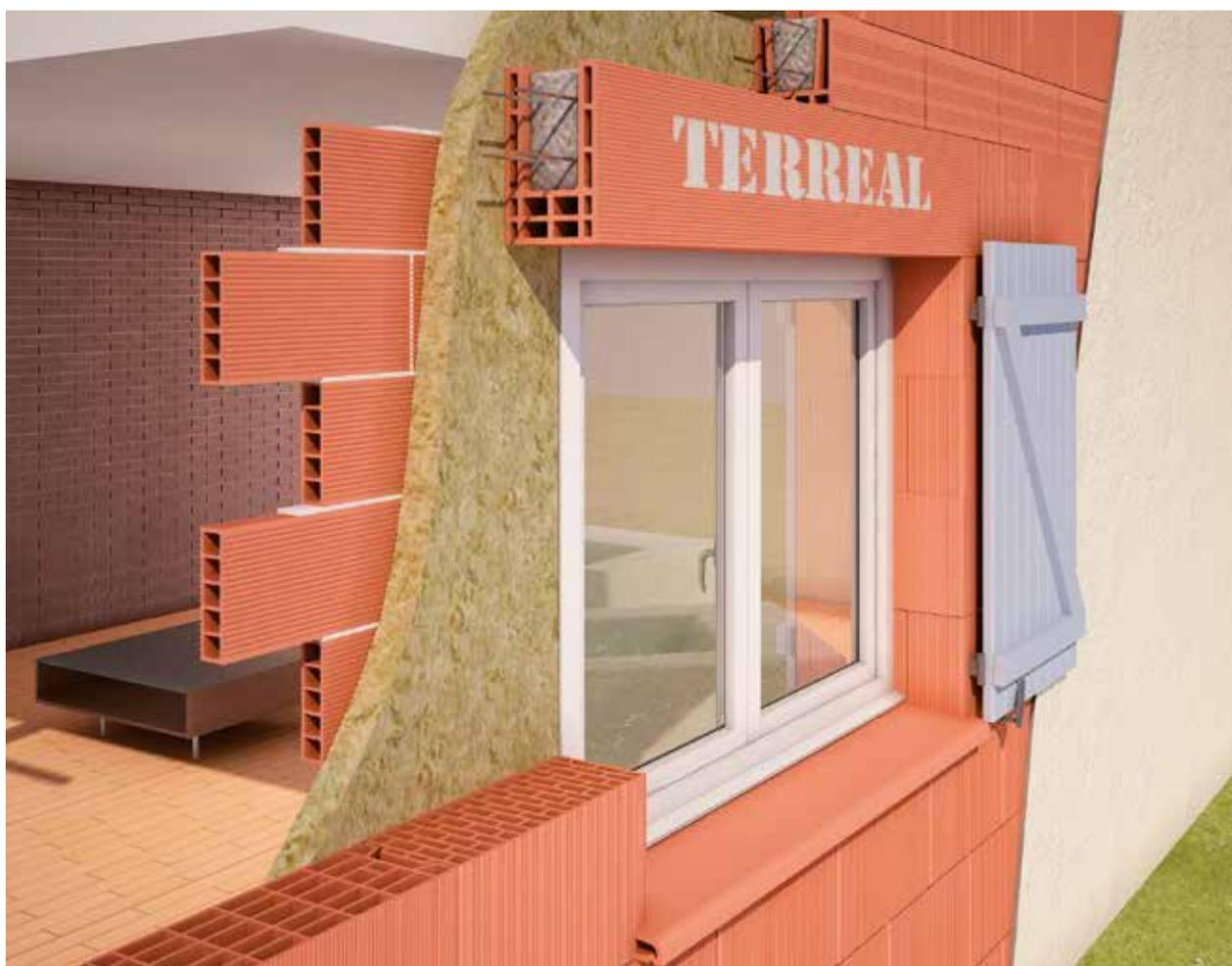
Les Maxi-linteaux TERREAL sont classés support d'enduit type RT3 (conformément au cahier du CSTB 2973). Il convient de vérifier le dimensionnement du linteau béton armé en fonction du chantier.
