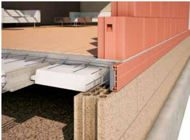
Plancher bas sur vide sanitaire avec hourdis isolant
