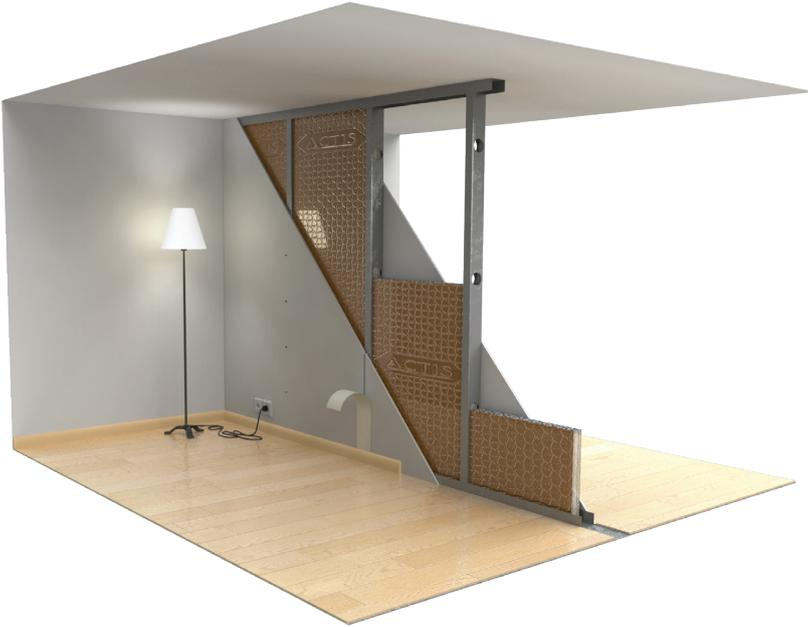
HYBRIS se pose de manière traditionnelle, glissé entre les rails de l'ossature métallique de la plaque de plâtre.
