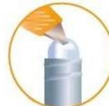
Couper le clip de sertissage à l'aide d'une pince coupante ou perforer le bout visible de la poche à l'aide d'un cutter.
