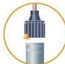
Replacer l'embout du pistolet muni de l'adaptateur et de la buse d'injection.
