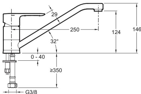
Descriptif CCTP : Mitigeur évier, bec profilé. E16084-4. Collection : JULY. POIDS : 1,2 kg. NORMES ET RÉGLEMENTATIONS : NF : I - ECAU : E0 C2 A2 U3 (Ge3) - ACS : 11 ACCLY 540. TYPE : Mitigeur. DÉBIT (L/MN SOUS 3 BARS) : 10 l/mn. MÉCANISME : Cartouche à disques céramique. ECO CONSO : Economie d'eau. VIDAGE : Sans vidage. TYPE DE ROBINETTERIE DE CUISINE : Mécanique. TYPE DE BEC : Pivotant. TYPE D'INSTALLATION : 1 trou. GARANTIE MÉCANISME : 5 ans. PERCEMENT : Ø 35 mm. Bec profilé orientable.
