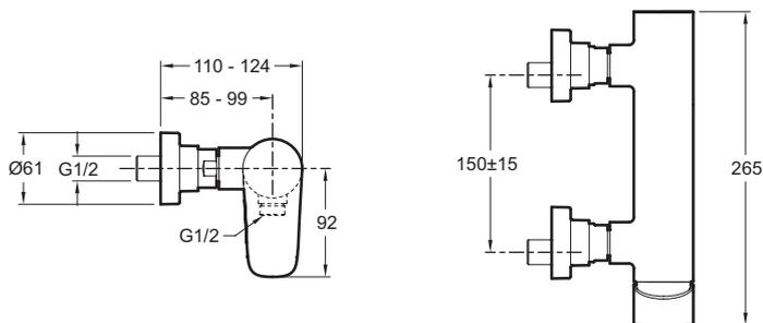
Descriptif CCTP : Mitigeur douche mural. E72351. Collection : ALEO. POIDS : 1,9 kg. TYPE D'INSTALLATION : Mural. NORMES ET RÉGLEMENTATIONS : NF : IA - ECAU : E1 C2 A3 U3 (Ge3) - ACS : 10 ACCLY 113. DÉBIT (L/MN SOUS 3 BARS) : 14 l/mn. RACCORDS : Avec raccords et rosaces murales. MÉCANISME : Cartouche à disques céramique. ENTRAXE (MM) : 150 ± 15. TYPE D'INSTALLATION : 2 trous. CLAPET ANTI-RETOUR : Yes. GARANTIE MÉCANISME : 5 ans. GARANTIE FINITION : 10 ans.
