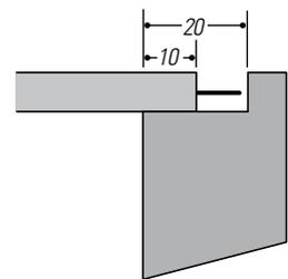
Appui minimum de 10 cm pour un ancrage de 20 cm.
