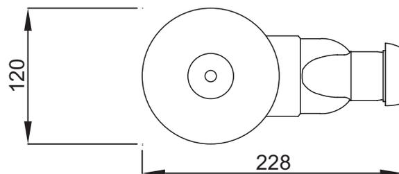
Descriptif CCTP : Bonde siphonide. E78168. Collection : HORS COLLECTION. DIAMÈTRE DE BONDE : 90 mm. TYPE D'ACCESSOIRE : Bonde. Débit 36 l/mn. Encombrement réduit 58 mm.
