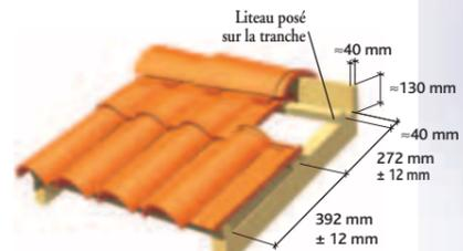
Faîtière/arêtier à pureau variable ou à bourrelet à emboîtement et tuile sous-faîtière 2/3 pureau.
